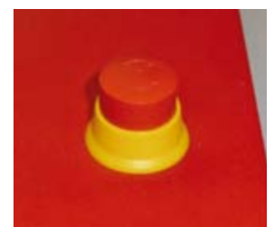
Der rote Pilzknopf-Schalter schaltet eine Maschine schnell und sicher ab.
