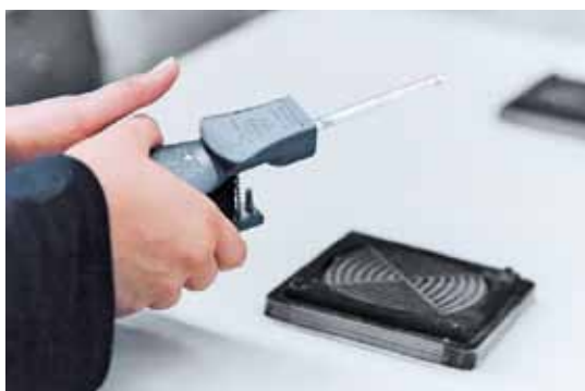
Einfache Messung der Ozonkonzentration mit einem Prüfröhrchen
