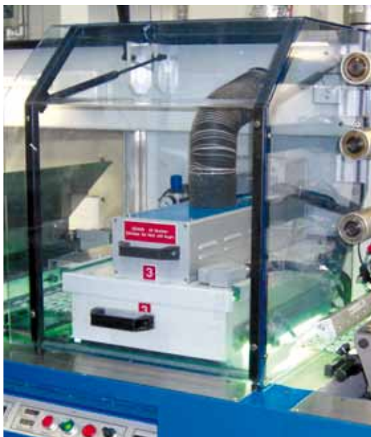
Zusätzliche Abschirmung des gesamten UV-Strahlers, die Licht durchlässt, aber UV-Strahlung absorbiert
