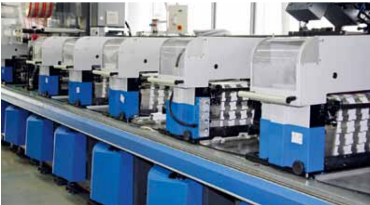
Trennende Schutzeinrichtungen an einer Etikettendruckmaschine
